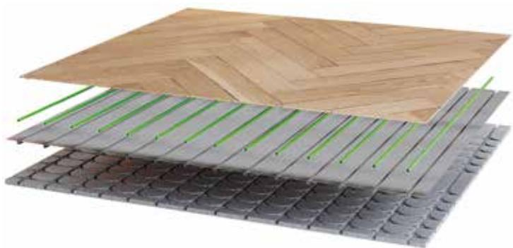
Les plaques préformées en EPS (entraxe de 10cm) affichent une valeur d'isolation de 0,48 Rd et peuvent être utilisées avec les profilés thermoconducteurs AluTherm et le tuyau de chauffage SpeeTube Ø10mm. Les plaques EPS doivent être posées de manière flottante sur un support parfaitement plat (il n'est pas nécessaire qu'il soit de niveau) et à une distance de 3mm des murs.
