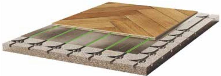
Les plaques préformées en EPS (entraxe de 10cm) affichent une valeur d'isolation de 1 Rd et peuvent être utilisées avec les profilés thermoconducteurs AluTherm et le tuyau de chauffage SpeeTube Ø10mm. Les plaques EPS doivent être posées de manière flottante sur un support parfaitement plat (il n'est pas nécessaire qu'il soit de niveau) et à une distance de 3mm des murs.
